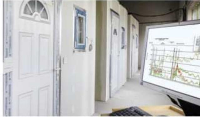
3 cellules d'essais des études 1 et 2 pour mesurer l'absorption et le relargage du formaldéhyde.
